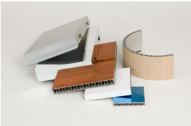
Конструкция панелей является многослойной: на основе применения материалов с сотовой структурой (лицевой и внутренний слои панели связаны между собой алюминиевой ячейкой, имеющей сотовую структуру) по типу сэндвич панели с внутренним наполнением. Технология применяется в авиа-, судостроении.
